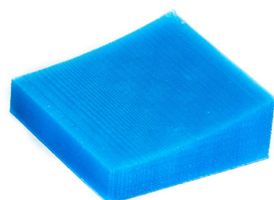
Comment la hauteur de couche affecte la surface de l'objet
